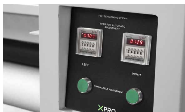
Sistema automático de centrado del tapete de fieltro a través de PLC.
