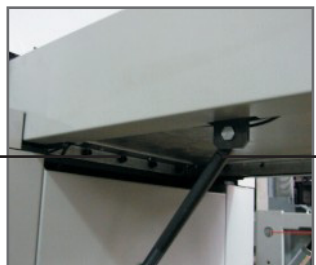
Apriete los tornillos y amortiguador al chasis y a la mesa trasera
