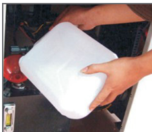
Rellene con aceite hidráulico, ayúdese de un embudo
