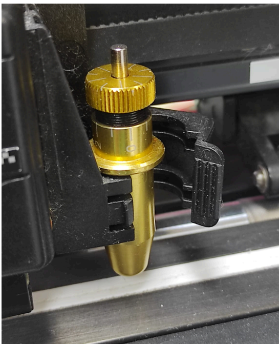
Abrazadera de clip abierta con portacuchillas encajado y abrazadera con el clip cerrado
