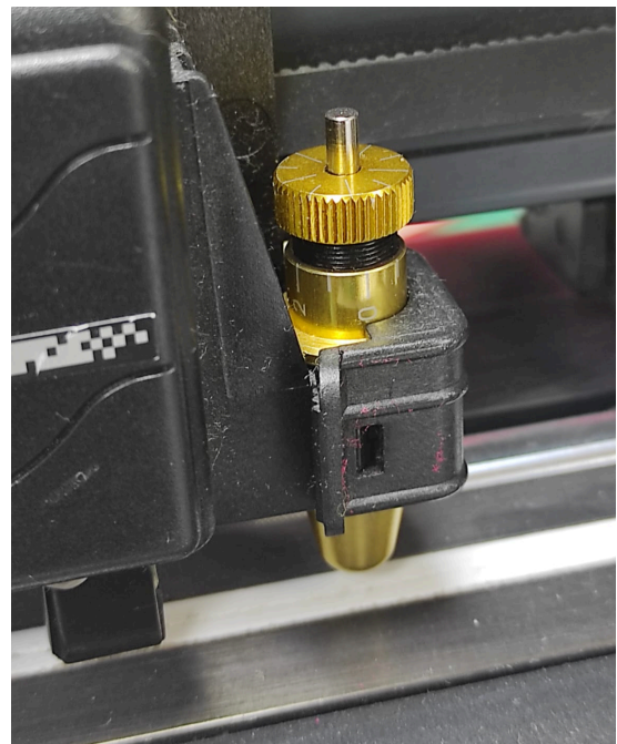
Abrazadera de clip abierta con portacuchillas encajado y abrazadera con el clip cerrado
