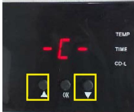
Pulsa el botón OK, el visualizador indica C que se refiere a grados centígrados. Pulsa las flechas ^ o v para seleccionar "C" para medir la temperatura en grados centígrados o "F" para Fahrenheit.
