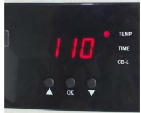
Pulsa el botón OK, el piloto de temperatura se encenderá. Pulsa las flechas ^ o v para configurar la temperatura según el producto. Nota: la temperatura aparecerá indicada en el visualizador solo después de alcanzar los 100°C. Es normal que la temperatura no aparezca indicada cuando se acaba de encender la plancha.
