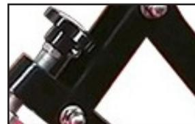
Tornillo de ajuste de presión: Para ajustar la presión fácilmente al sublimar elementos con diferentes espesores.
