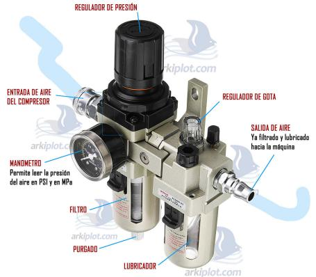
En la maquinaria suele haber un componente, el filtro regulador lubricado o FRL cuya misión es filtrar, lubricar y regular la presión del aire comprimido que llega desde el compresor mediante el accionamiento de un tornillo regulador de presión que abre y se cierra el caudal de aire comprimido reduciendo o aumentando la presión de entrada del aire a los valores requeridos por nuestra maquinaria (presión de trabajo).
