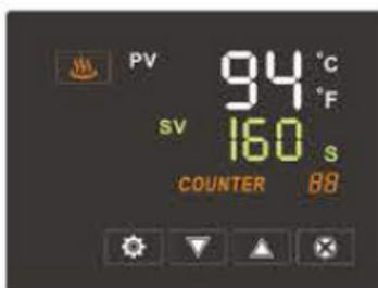
Al encender la plancha, el controlador con pantalla LCD se iluminará. **PV** indica el valor de temperatura actual.
