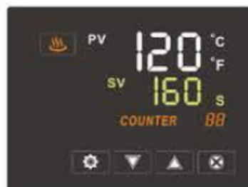
Finalmente pulse **SET** para terminar la configuración. Cuando el indicador **PV** alcance la temperatura configurada podrá pulsar la doble botonera, comenzando la transferencia, cuando termine el tiempo el plato de calor se abrirá automáticamente.
