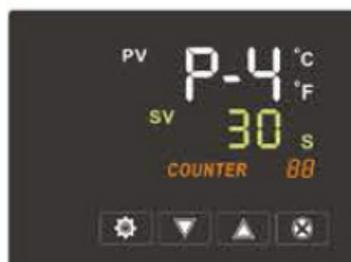
**P-4 Ajuste de presión.** Pulsa **SET** y **▼▲** para ajustar los diferentes niveles de presión en rango de 1 a 35. Para textil las presiones típicas van de 28 a 35.
