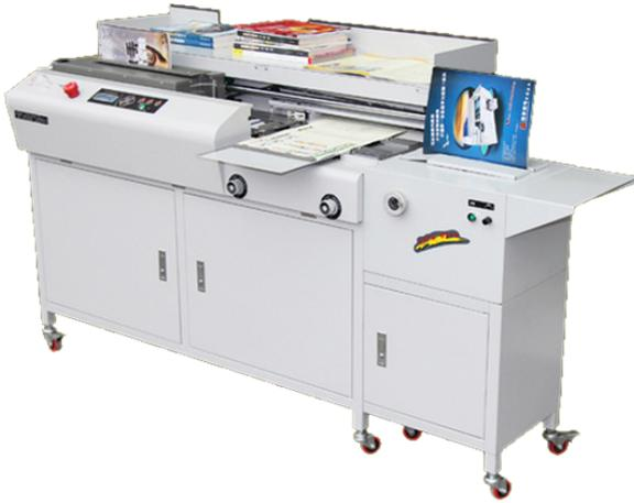
Fresadora - encoladora de uso profesional con módulo de **hendido de cortesía**. Encuaderna ejemplares de hasta **310mm** de longitud máxima de lomo y **58mm** de grosor. Su sistema de desbarbado y fresado, así como el uso de un colero especial, permite conseguir un perfecto agarre de las hojas, dando un acabado de gran calidad con costes reducidos.
